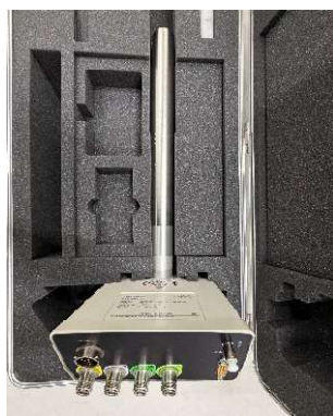
図 1-1 液体用検出器の全体と検出器先端部の形状
