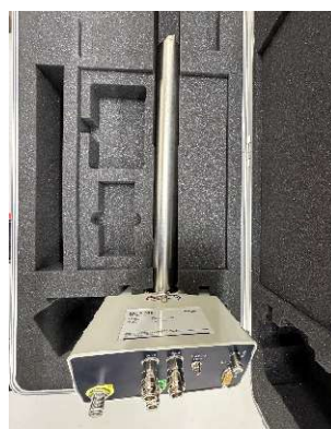
図 1-2 固体用検出器の全体と検出器先端部の形状
